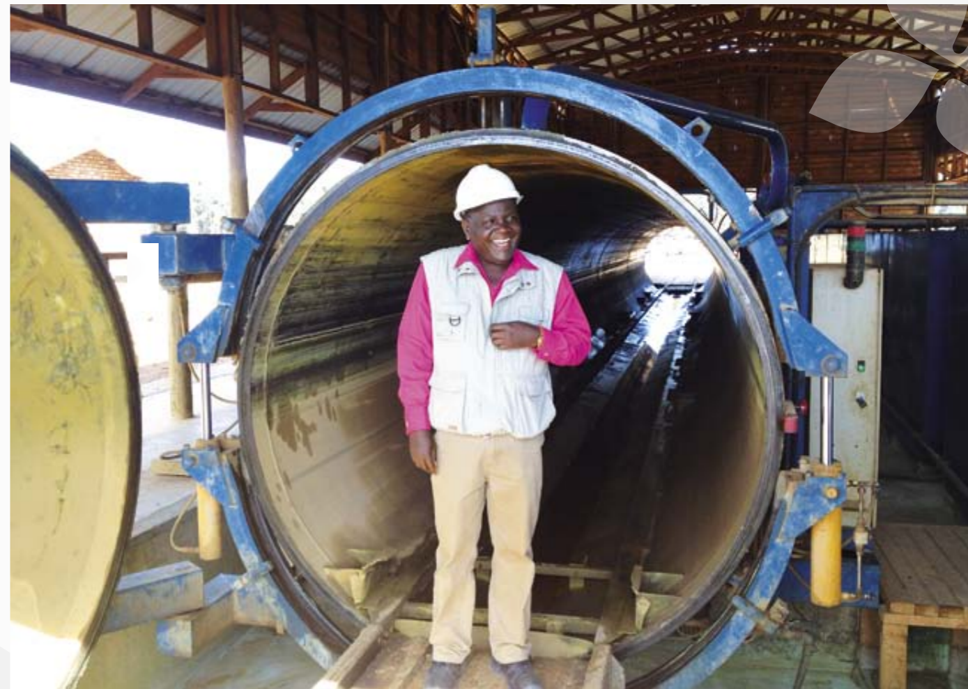
Martin Kawonga ved en maskin for impregnering av stolper ved Green Resources treplantasje i Sao Hill, Tanzania.
